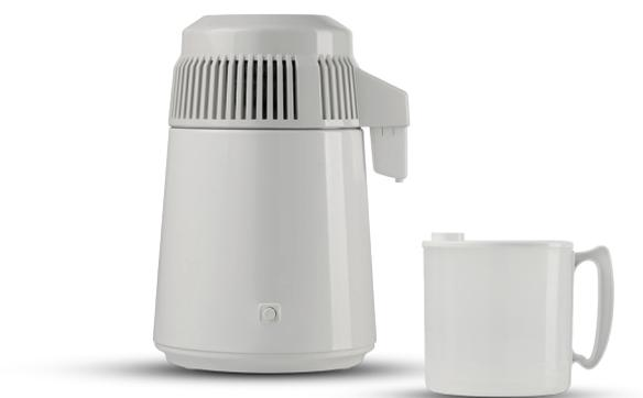
Distillateur d'eau permettant d'obtenir de l'eau distillée par ébullition et condensation ultérieure de la vapeur. Il distille 0,7 l d'eau par heure. Capacité 4 litres. Il répond aux tests de sécurité et de compatibilité électromagnétique (2014/30/UE) et de basse tension (2014/35/UE).
