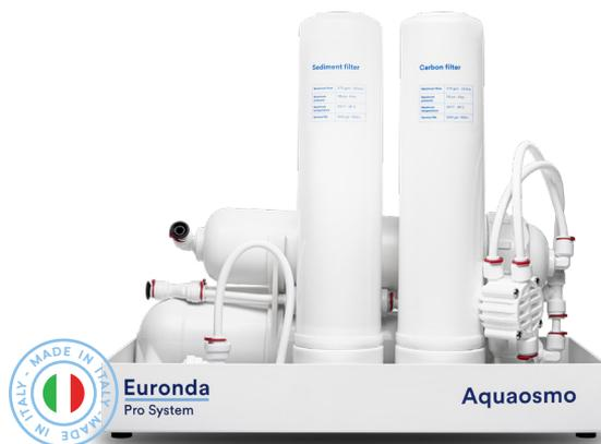
Appareil de production d'eau osmosée par osmose inverse conçu pour les cliniques ayant une eau très dure. Le système de filtration élaboré, composé d'un filtre à sédiments et d'un filtre à charbon, d'une résine et d'une membrane osmotique, garantit une production d'eau de qualité supérieure, adaptée à l'alimentation des autoclaves et de tous les équipements du cabinet, conformément à la norme EN 13060 (<math><15 \mu\text{s}/\text{cm}</math>).
