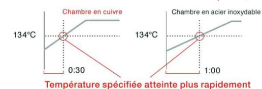
Comparaison de stabilité de température entre chambre en cuivre et chambre en acier inoxydable
