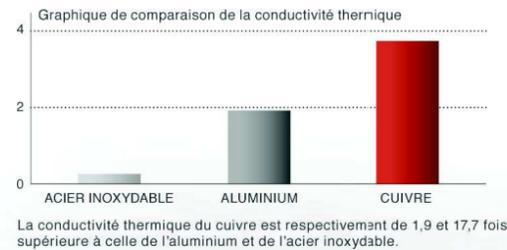
La conductivité thermique du cuivre est respectivement de 1,9 et 17,7 fois supérieure à celle de l'aluminium et de l'acier inoxydable.
