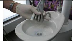
Appuyez sur le bouton de rinçage (aussi appelé « purge ») jusqu'à la fin de la bouteille.
